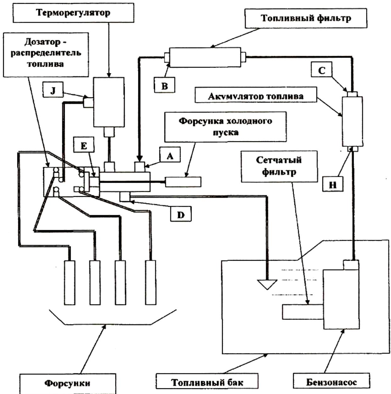
*Алгоритм измерения давления в системе механического впрыска (измеряется последовательно в точках B, C, H - СХЕМА M1).*
