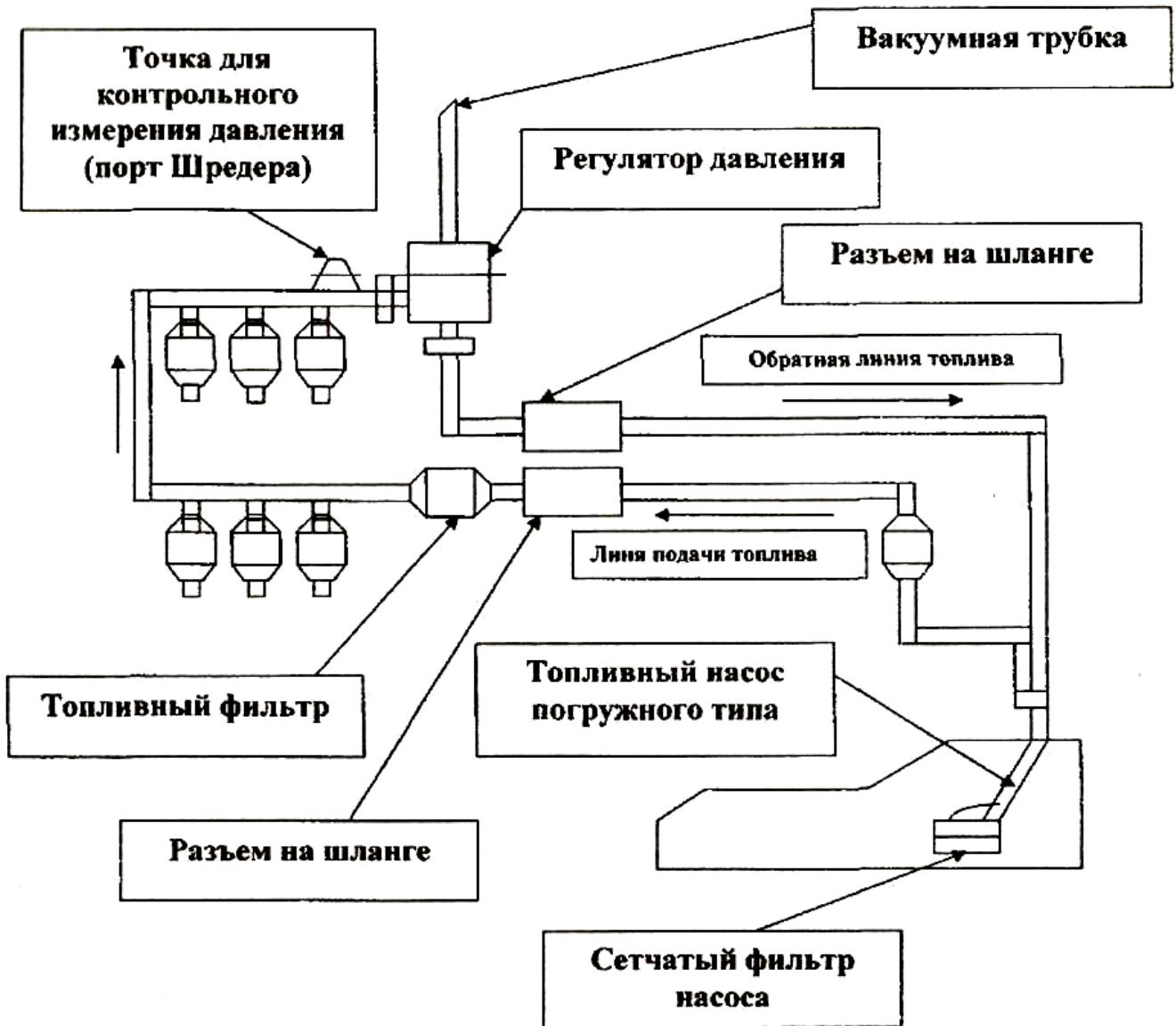
ПРИНЦИПИАЛЬНАЯ СХЕМА МОНОВПРЫСКОВОЙ СИСТЕМЫ.
