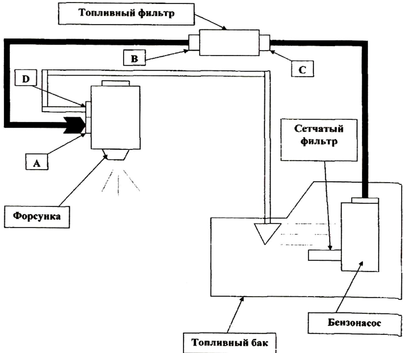
*Алгоритм измерения давления в системе с «моновпрыском»*
